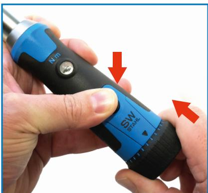
Drücken Sie den Sicherungsknopf am Handgriff und schieben Sie gleichzeitig den Einstellring hinein
