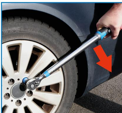
Drücken Sie den Drehmomentschlüssel in der Mitte des Handgriffs in Uhrzeigersinn und stoppen Sie direkt nach einem Klick-Geräusch
