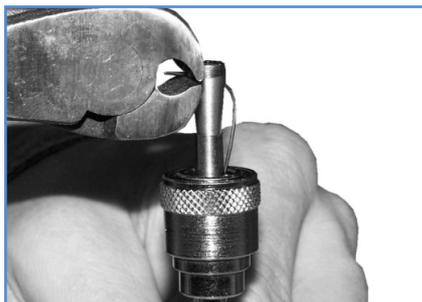
Schneiden Sie den Draht bündig an der Öse ab.
