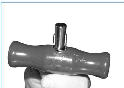
Führen Sie das andere Ende des Drahtes in die untere Öffnung des Sicherheits-Ziehgriffes, stecken ihn durch die obere Öse und knicken ihn um 180° ab. schließen Sie anschließend den Griff, um den Draht zu fixieren.
